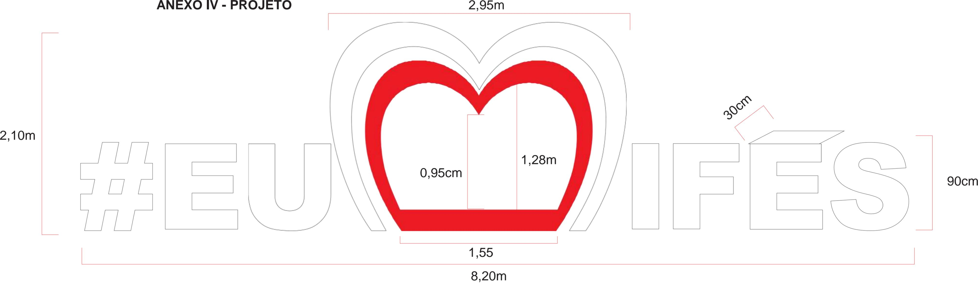
DEVERÁ SER ESTRUTURADO EM METALON GALVANIZADO 30X20, 20X20 E 50X30 NA 18, REVESTIDO EM CHAPA DE ALUMÍNIO COMPOSTO (ACM). AS CHAPAS DE ACM DEVERÃO RECEBER PINTURA AUTOMOTIVA PU COM CORES CONFORME PROJETO, INSTALAÇÃO NO LOCAL INDICADO
